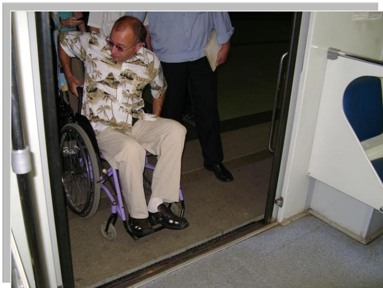
Входные двери в вагоне метро должны иметь ширину проема в свету не менее 90 см. Высота порога при входе в вагон с платформы должна составлять не более 2,5 см.
