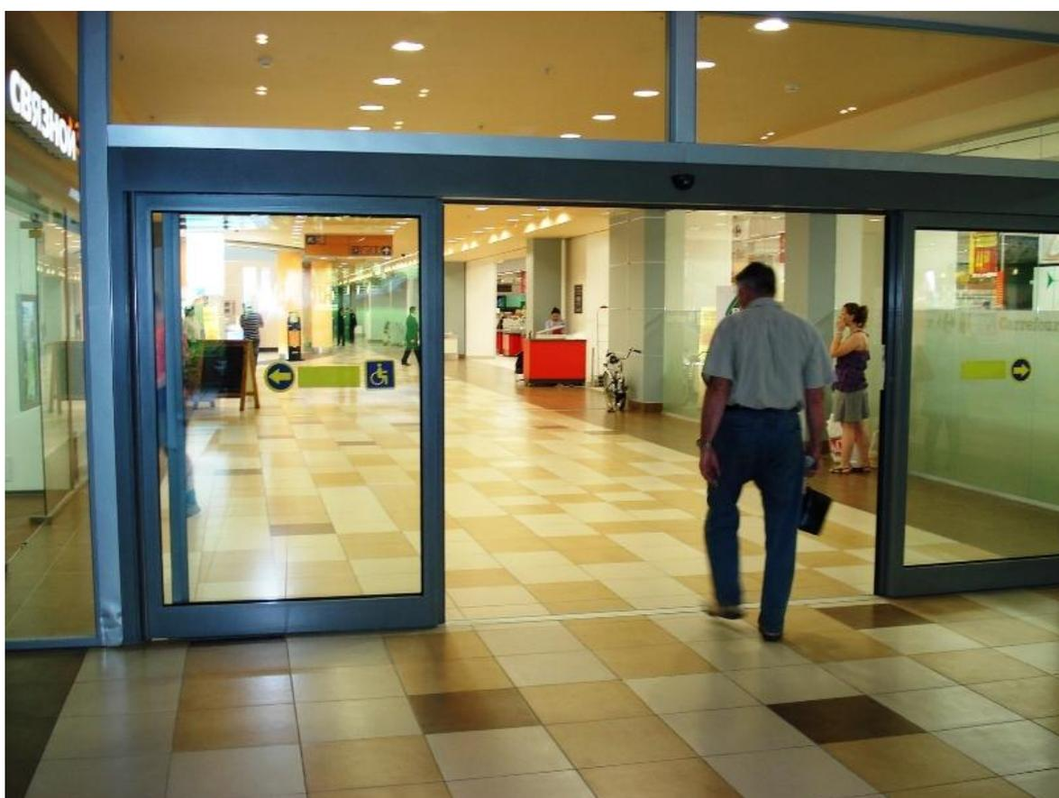
Поверхности покрытий входных площадок и тамбуров должны быть твердыми, не допускать скольжения при намокании и иметь поперечный уклон в пределах 1-2%.
