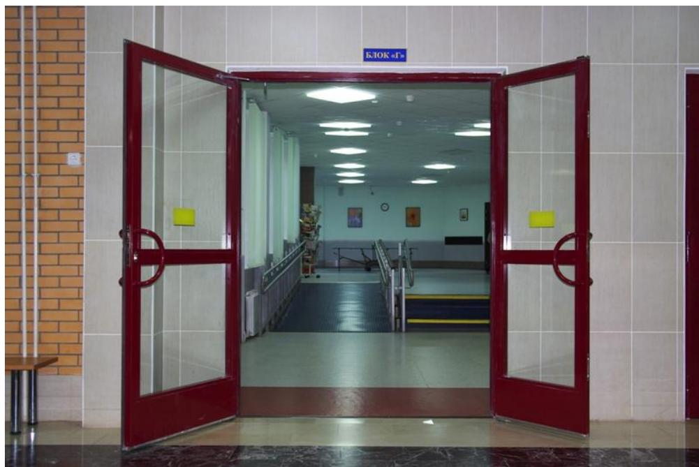
Дверные проемы не должны иметь порогов и перепадов высот пола. При необходимости устройства порогов их высота не должна превышать 0,025 м.
